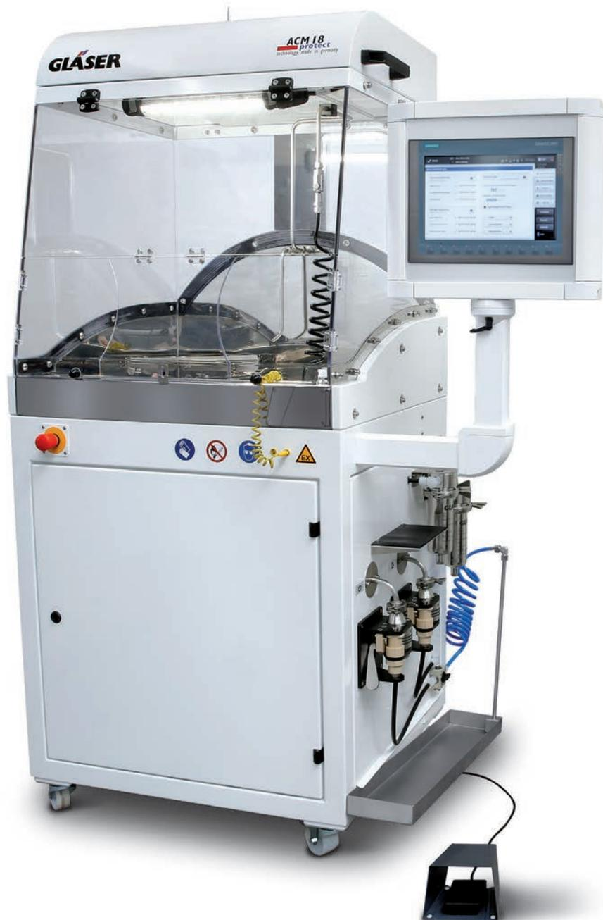
Anlage der zweiten Generation. Modernster Stand der Technik zur Prüfung der Technischen Sauberkeit an funktionsrelevanten Komponenten. Gemäß den Empfehlungen der VDA 19.1 Kapitel 11 für Arbeitssicherheit und Umwelt komplett überarbeitet. Die ACM18 ist bestens für Ihre zukünftige Anforderungen ausgestattet.
