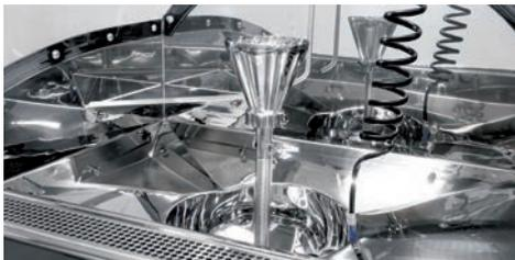
**ANALYSEBECKEN** (600 x 750 mm) aus poliertem Edelstahl. Für Bauteile bis zu 15 kg. Prüfung von Kleinbauteilen mit hohen Anforderungen im optionalen Trichter. Absaugleiste im vorderen Bereich.
