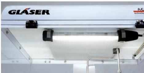
**ZUFÜHRUNG** gefilterter Luft über die Decke der Prüfanlage. Aktiver Schutz der Bauteile und des Beckens vor Partikelkontamination. Somit ergibt sich eine Reinraumklasse ISO 5 im Analyseraum. Erhöhter Mitarbeiterschutz durch Anschluss Ihrer Absaugung an unser System.
