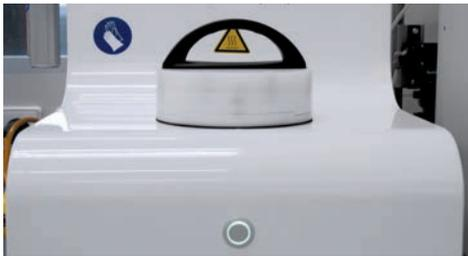
**LEUCHTDIODE** zur einfachen Unterscheidung von sechs Betriebsmodi durch unterschiedliche Farbgebung mit zusätzlichem akustischen Signal z. B. „Trocknungsprozess beendet“.
