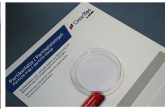
Messzeit: Partikel lagern sich auf der Klebefläche ab Test period: sedimenting particles collect on adhesive surface
