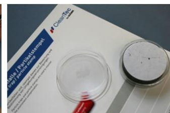
Stempeln: Partikel bleiben auf der Klebefolie haften To stamp: particles collect on adhesive label
